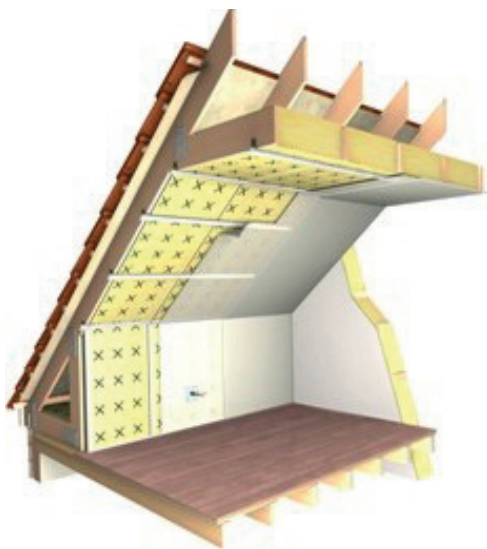
Fig.100 Izolim termik i kulmit dhe të pllakës
