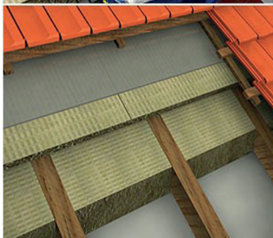
Fig. 101 (a) izolim termik në pllakë tavani, (b)izolim termik në dysheme, (c)izolim termik në kulm të pjerrët, (ç)izolim termik në tavan të pakalueshëm
